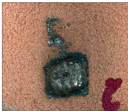
Bild 6: SAC-Lot auf Kupfer, blank gelötet ohne Centrotherm-H 2 O-Plasma
