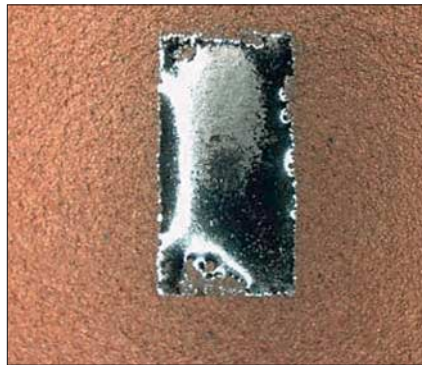
Bild 5: SAC-Lot auf Kupfer, blank gelötet mit Centrotherm-H 2 O-Plasma
