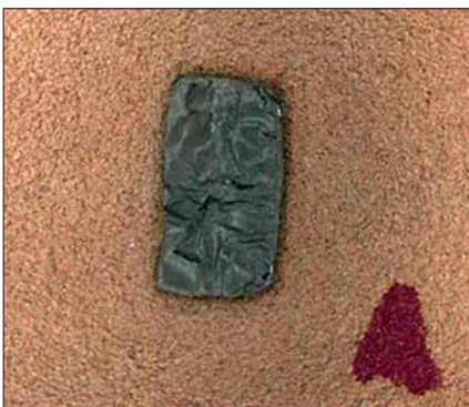
Bild 4: SnPb-Lot auf Kupfer, blank gelötet ohne Centrotherm-H 2 O-Plasma
