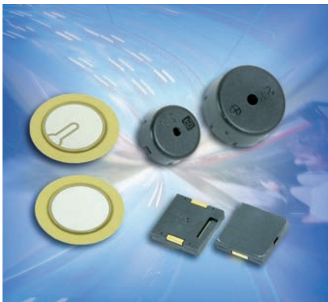
Gehäusevarianten piezoelektrischer Schallgeber: piezoelektrische Membran ohne und mit eingebautem Treiber, Schallgeber mit Anschlussstiften und SMD-Schallgeber (von unten links im Uhrzeigersinn).
