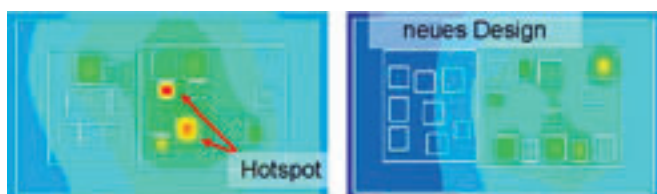
Vergleich eines konventionellen Designs mit der LTI-Technologie: Der Anteil der Hotspots hat sich durch die LTI-Technologie, der homogenen Anordnung der IGBT und der Chiptechnologie der 6. Generation deutlich verbessert.
