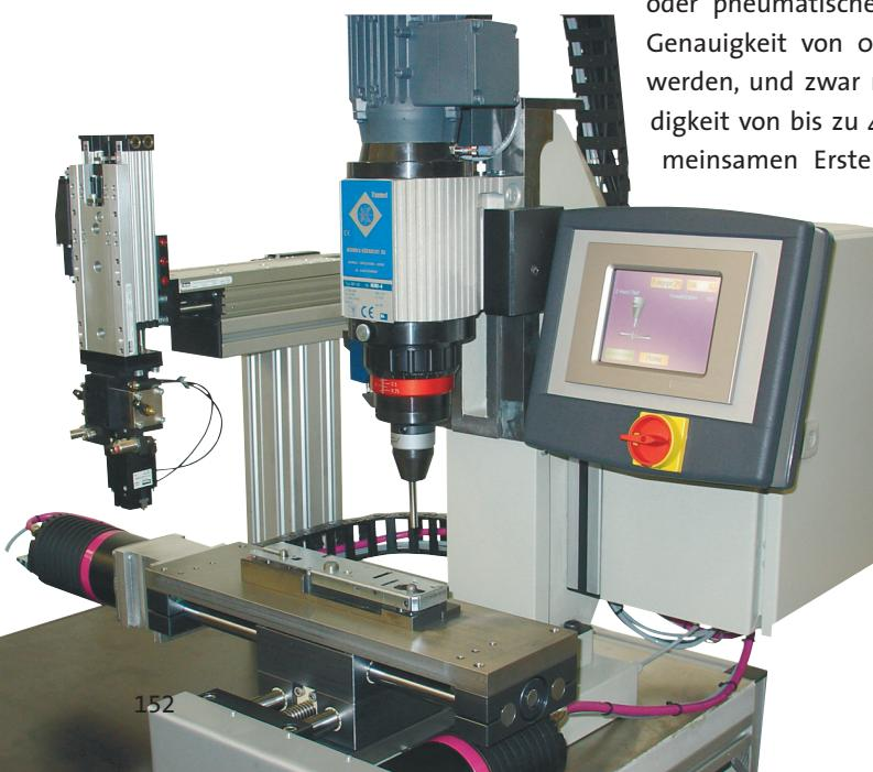
**Niet- und Nagelfest:** Die Nietmaschinen können automatisch verschiedene Nietverbindungen herstellen und sind auch in der Lage, Kunststoff zu nielen.
