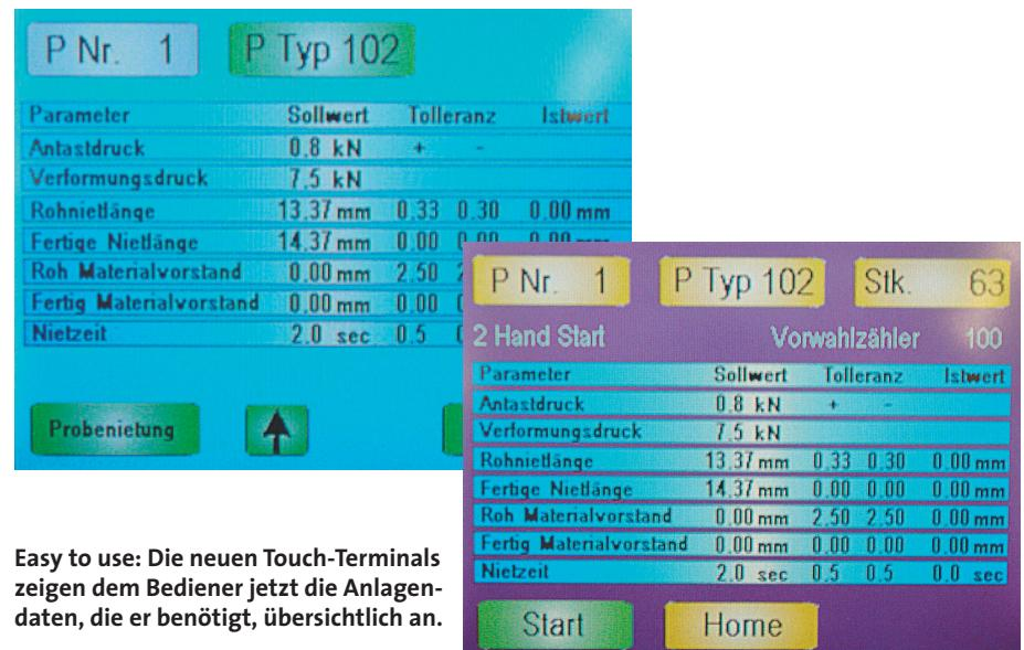
Bewegung eines CNC-Tisches und SPS-Funktionen, beispielsweise für die Ausrichtung von Niederhaltern, mit übernehmen. Viele weitere Funktionen, wie die Aufzeichnung der Zyklusdaten für das Qualitätsmanagement, lassen sich auf einfache Weise in den IPC eingeben.
