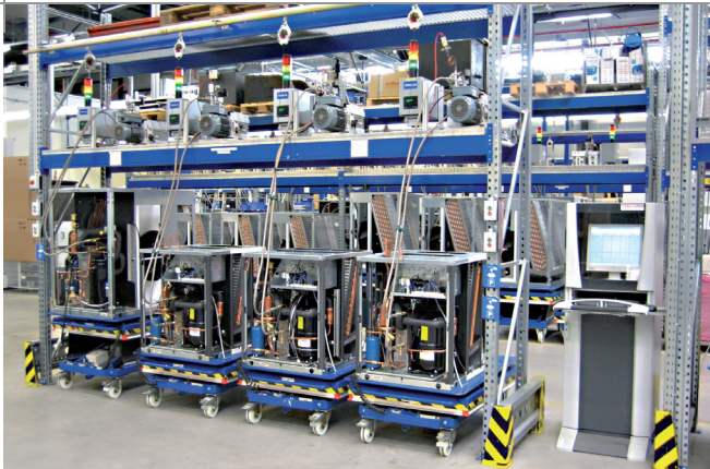
Ein Überwachungsplatz kontrolliert mehrere Evakuierungsanlagen
