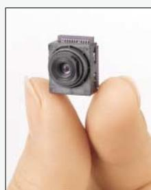
Im August 2003 stellte Sharp das mit 1,44 cm<sup>3</sup> seinerzeit kleinste und schlankste 1-Megapixel CCD-Kameramodul LZoP3721 vor. Diese Entwicklung ebnete den Weg für die Miniaturisierung von Mobiltelefonen mit Digitalkameras der Megapixel-Klasse.
