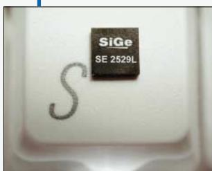
Der Leistungsverstärker SE2529L von SiGe Semiconductors kam im Januar 2003 auf den Markt und wurde bis heute über 20 Millionen mal ausgeliefert. Er ist ein hoch linearer, dreistufiger Leistungsverstärker zur Verbesserung der Leistungsdaten von 4 GHz-802.11b/g-WLAN-Systemen und bietet eine Ausgangsleistung von +18dBm bei voller FCC- und 802.11g-Konformität. Diese verbesserte Ausgangsleistung bei einer sehr niedrigen Fehlerratenquote gewährleistet einen höheren Datendurchsatz über längere Zeit.
