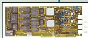
1991 entstand bei Spectrum Systementwicklung mit der PAD82 einer der weltweit ersten schnellen Digitizer für den ISA-Bus des PC. Mit 2 synchronen 8 Bit Kanälen und 100 MS/s Abtastrate und einem maximalen Speicher von 2 MByte kann die Karte auch heute noch von den Eckdaten mit halten. Obwohl inzwischen bei schon der zweiten Nachfolger (natürlich auf PCI-Basis) im Einsatz ist, wurden von der PAD82 noch bis 2003 einige 100 Stück zu einem damaligen Preis von 5650 DM verkauft.
