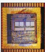
freescale, damals Motorola, kündigt den ersten echten 32-Bit- $\mu$ P an, den 68020. Weitere Meilensteine waren MC68HC11 (Bild), DSP96001 32-Bit-DSP und 1989 der MC68302, der erste Multi-Protokol  $\mu$ P. Bis 1996 wurden mehr als 2 Mrd. MC6805 und mehr als 500 Mio. 68HC11  $\mu$ Cs ausgeliefert.
