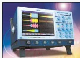
Im Jahre 2002 präsentierte LeCroy mit dem WaveMaster sein erstes Oszilloskop mit einer komplett neuen und patentierten X-Stream Architektur auf SiGe Basis. Die Geräte verfügen zum damaligen Zeitpunkt mit 3 GHz bis 6 GHz Bandbreite, 20 GS/s Abtastrate und bis 100 M Speicher pro Kanal über die führenden Spezifikationen im Markt und ermöglichen es LeCroy, seine Position im oberen Oszilloskop Marktsegment deutlich auszubauen.
