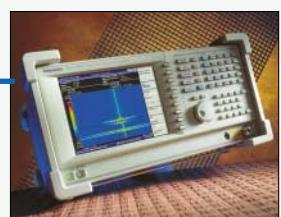
Tektronix bringt den RSA3408A auf den Markt, einen Echtzeit-Spektrumanalysator mit einem Messbereich von 0 Hz bis 8 GHz. Er hat eine 36 MHz breite Echtzeit-Triggerungs- und Erfassungsmöglichkeit sowie eine 2000-fach verbesserte Auflösung bei der Analyse von zeitlichen Leistungs- und Frequenzänderungen.
