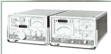
Der Kommunikationsmessgerätespezialist Wandel & Goltermann (jetzt Acterna, zukünftig JDS Uniphase) präsentierte den leicht transportierbaren Gruppenlaufzeit- und Dämpfungsmessplatz LD3 für den Frequenzbereich 200 Hz bis 20 kHz. Er besaß einen Sende- und Empfangspegelbereich -50 bis +10 dBm sowie digital einstellbare Wobelgrenzen und digitale Frequenzanzeigen.
