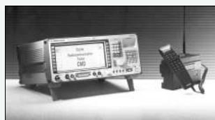
Der CMD von Rohde & Schwarz war der erste GSM-Kompaktmessplatz, ausgestattet mit zwei HF-Generatoren, Spitzenleistungsmesser, NF-Generator und NF-Voltmeter, Klirrfaktormesser sowie NF- und ZF-Frequenzzähler, diversen Schnittstellen und vieles anderes mehr.
