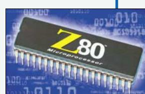
1975 wurde der Z80 entwickelt, der kompatibel zu Intels 8080 war, aber sonst mehr bot (Mehr Register, einfaches Ein-Design). Der 8-Bit-µC kam dann 1976 auf den Markt und war der Renner in vielen Applikationen in den 70er und 80er Jahren mit Taktraten von 6...20 MHz. 1987 kam der Z280 als 16-Bit und später folgte der Z380, Z80 Encore u. a.
