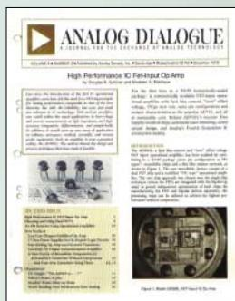
Der erste OpAmp mit FET-Eingang war der AD503 von Analog Devices. Untergebracht im dichten TO-99 bot er pinkompatibel zum berühmten AD741 5pA Biasstrom, 5V/µs Anstiegsrate und Zero-Offsetspannung. Er wurde in Millionen Stückzahlen verkauft.
