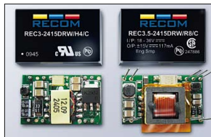
Bild 3: Beim REC3.5 mit „Re 3 -Inforced“-Isolation (rechts) sind Trafo und Optokoppler etwas größer als beim „Basic“-isolierten REC3 (links), aber Gehäusegröße und Pin-Out sind identisch.
