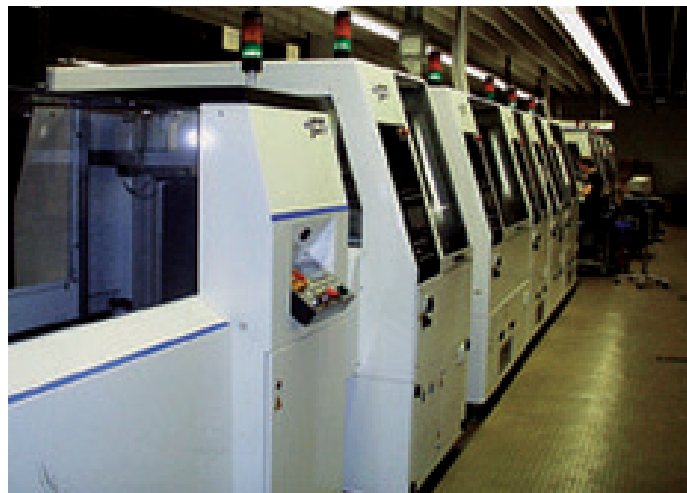
Bild 2: Eine der zwei vollautomatischen Endmontagelinien von JOT bei Friwo
