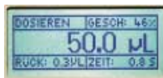
Bild 2: Die Darstellung an einem LCD zeigt alle eingestellten Werte und signalisiert den Grad der Auslastung des Systems
