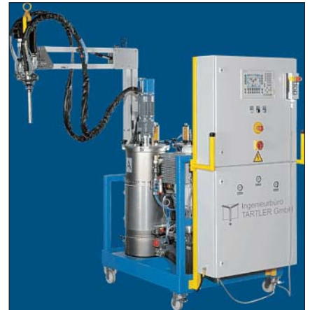
Bild 2: Vollautomatisierte und volumenstromgeregelte Mischanlage der Serie Nodopur von Tartler
