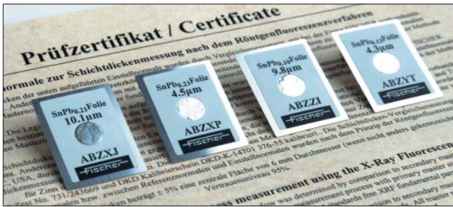
Bild 5: Helmut Fischer bietet auch Sn-Folien-Standards mit Zertifikat zur Kalibrierung der Messaufgabe Pb in Sn-Schichten an
