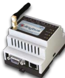
Anybus RemoteCom – Ausführung für Ethernet u. GSM/GPRS
