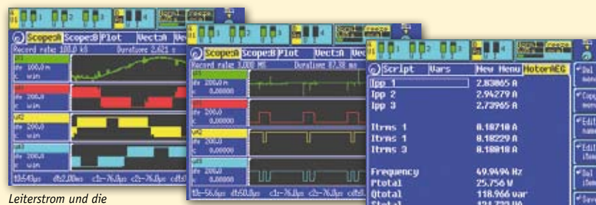
Besonders hohe Stromspitzen bei zeitgleichen Schaltflanken
