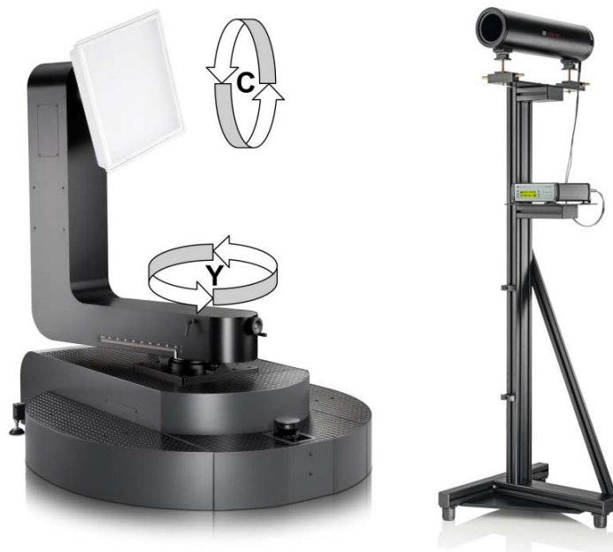
Abbildung 1: Leuchtenwender LGS 1000 (links) und Streulichttubus mit dem Detektor (Photometerkopf oder EOP) auf einem Ständer (rechts).
