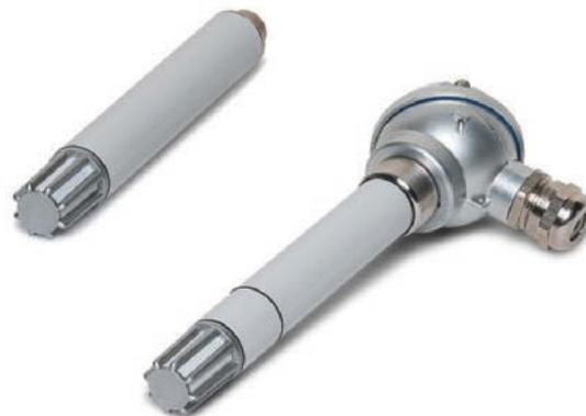
ren der I-Serie in den Reihen IA..., IR... werden standard-mäßig mit Gazefilter (Typ ZE17) bzw. in den Reihen IV... und IT... mit Edelstahl-Sintermetall-Filter (Typ ZE13) ausgeliefert. Für extreme Anwendungen (in Meeresnähe, in Wüsten, Gebirgen, Bereichen mit hohen Luftgeschwindigkeiten usw.) empfiehlt das Unternehmen Edelstahl-Sinterfilter.
