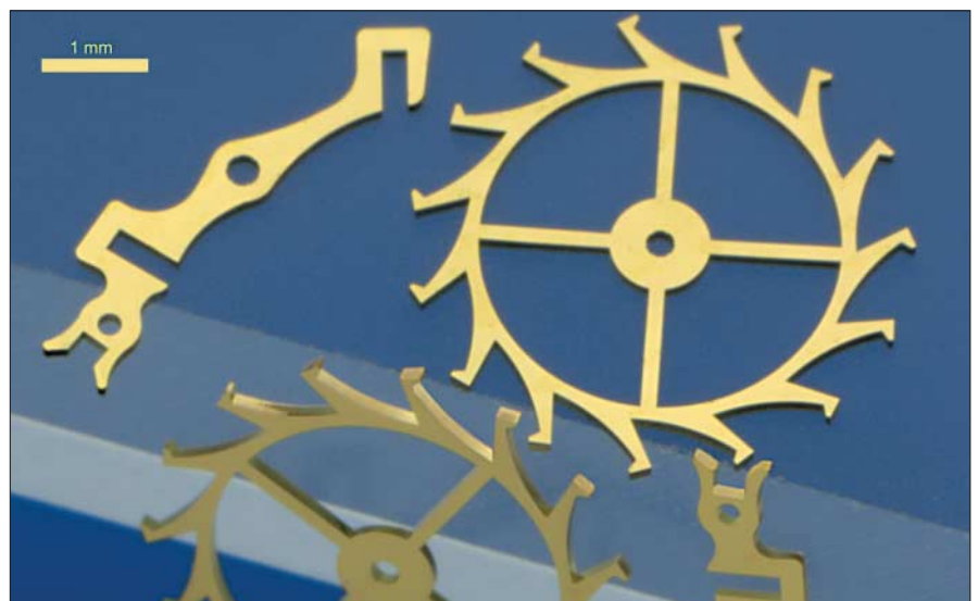
Bild 3: Die Fertigungsstraße für LIGA-Teile wird anhand einer Prototypenfertigung für Mikro-Zahnräder, die in Mikrogetrieben und Uhren zum Einsatz kommen, qualifiziert. Pro Wafer werden jeweils rund 1 000 Zahnräder aufgebaut (Bild: Forschungszentrum Karlsruhe)
