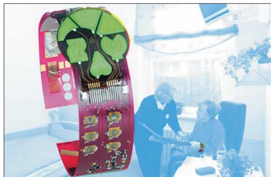
Bild 1: Demonstrator für ein Armband entwickelt, das Hautfeuchte und Temperatur zuverlässig überwacht
