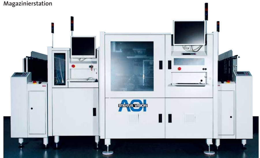
Bild 2: Integrierte AOI-Systemlösung von EPP mit Beladesystem, Reinigungsstation mit Luftmesser, AOI, Etikettendruck bzw. Kennzeichnen und Magazinierstation
