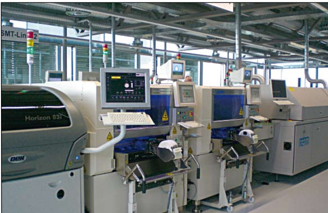
Bild 3: Die erst 2009 gekaufte SMT-Linie mit zwei Juki-Präzisionsbestückern im Neubau der Eltroplan
