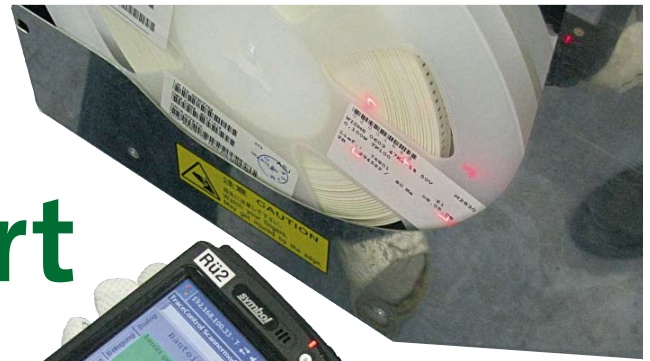
Bild 1: Barcodescanner beim Einlesen der Gebindeseriennummer
