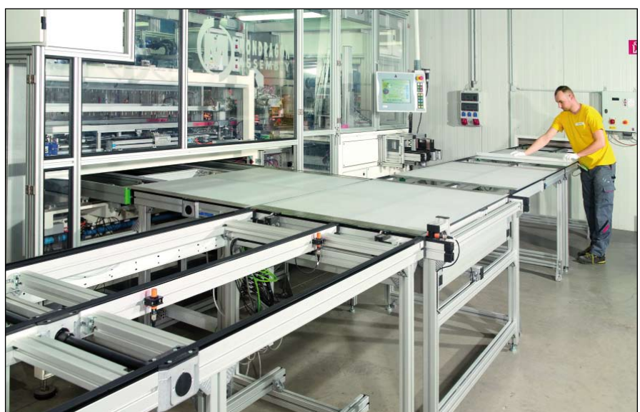
Bild 2: Die Vorspannung der Glasplatten erfordert einen extrem vorsichtigen Umgang und eine hohe Präzision des Transfersystems. An den Bandstrecken und Hub-/Quereinheiten installierte Anschläge mit Luftdüsen heben die aufliegende Folie kurz an, sodass die zerbrechlichen Scheiben jederzeit sicher und genau positioniert werden (Quelle: Bosch Rexroth AG)
