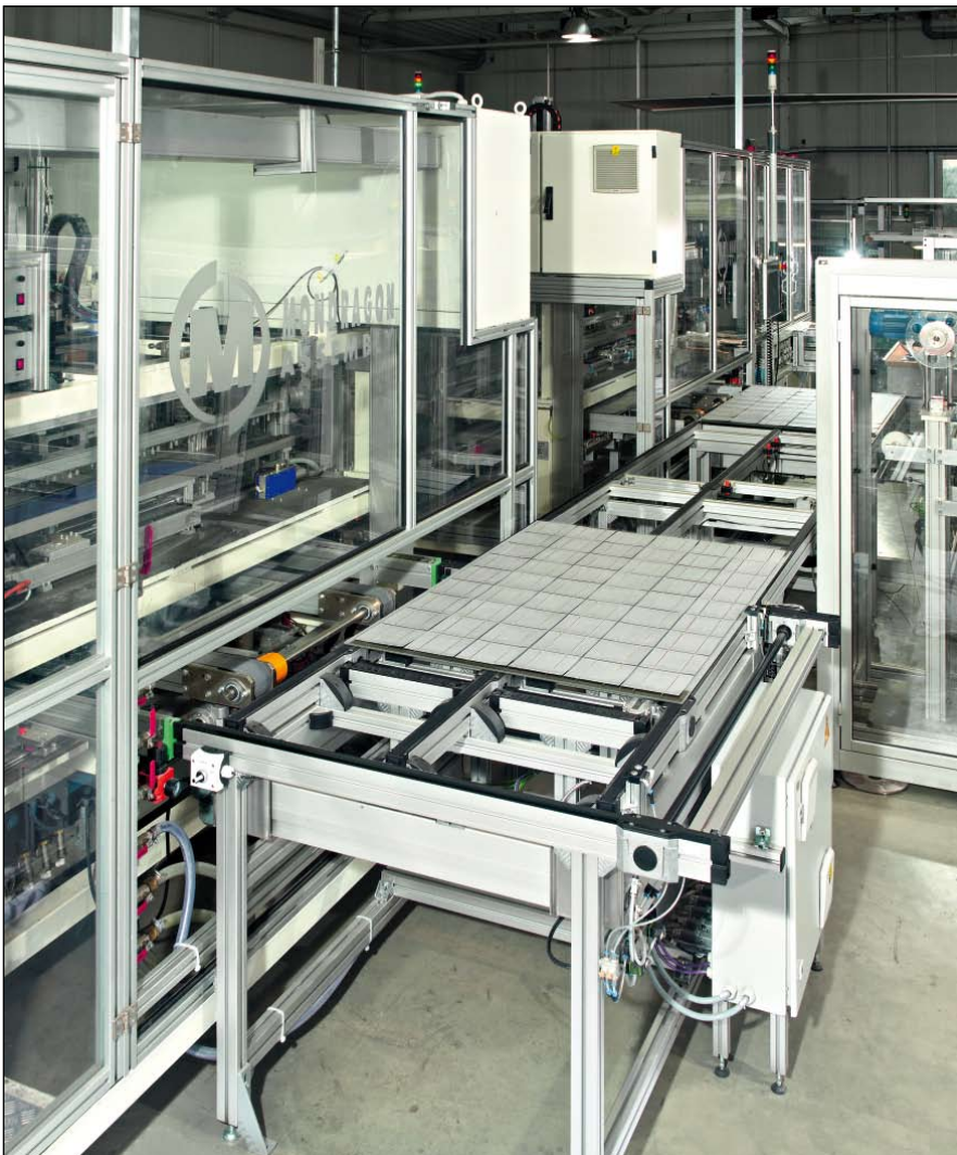
Bild 3: Versehen mit 54 aufgelegten Zellen transportiert das TS Solar die Solarglassscheiben zum Stringer. Für die Modulgröße von 1485 mm x 995 mm ist das Rexroth-Transfersystem TS Solar mit Dreifachspur ausgelegt
