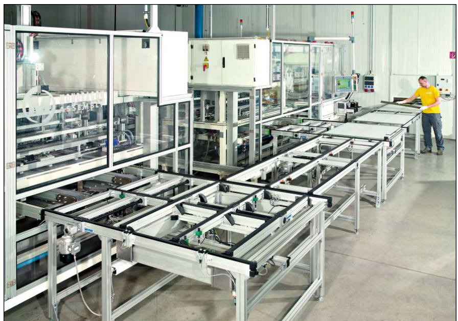
Bild 1: Alle Streckenelemente sind mit einem eigenen Antrieb ausgerüstet und Frequenzumrichter sorgen für sachte Beschleunigung und Verzögerung (Quelle: Bosch Rexroth AG)
