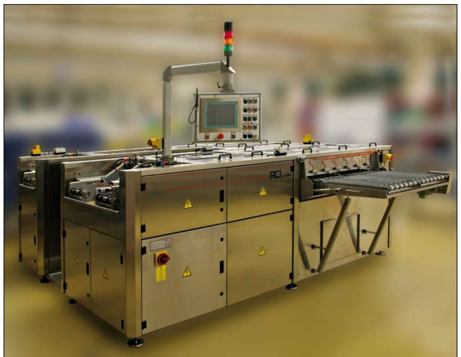
Bild 2: Die Ausstattung des Ecosplit mit drei Beladestationen ermöglicht einen Durchsatz von mindestens 4 300 Wafern/h
