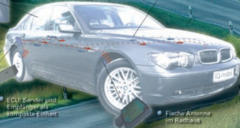
● Abfrage: Bidirektional Frequenz: Weltweit auf 2,45 GHz (Bluetooth)
