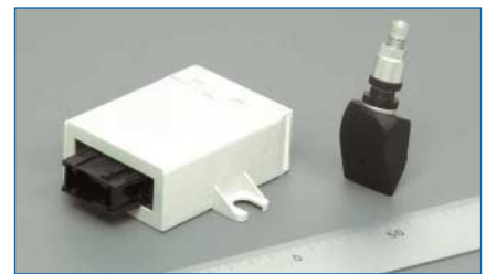
Bild 1: Zentrale Steuereinheit (links) und Transponder von RDKS.
