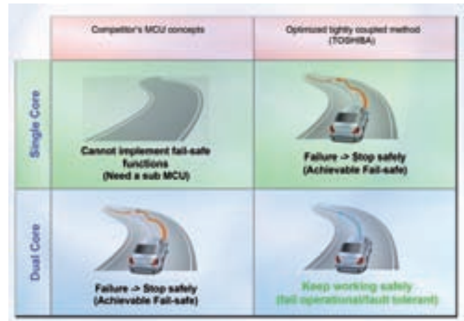
Bild 5: Dieses Konzept kann auch zur Entwicklung fehlersicherer oder fehlertoleranter Applikationen oder sogenannter 1-aus-2D-Systeme zum Einsatz kommen
