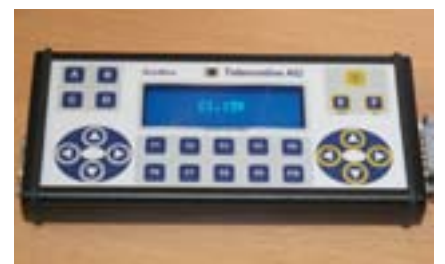
Bild 3: Diese CAN-Simulationsbox arbeitet ohne externen PC.
