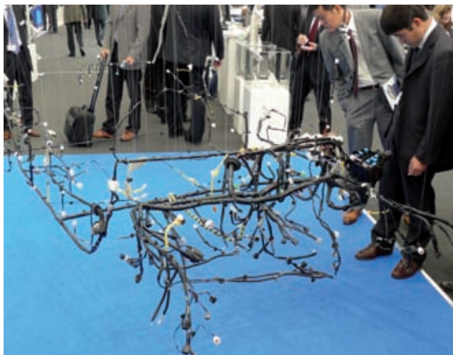
Bild 1: Fasziniert blieben die Besucher am Stand von Sumitomo Electric vor dem komplett frei im Raum „schwebenden“ Kabelbaum eines japanischen Kleinwagens stehen.
