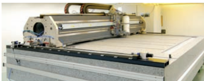
Die Lithographieanlage erstellt mit kurzwelligem, blauem Laserlicht kleinste Strukturen auf Masken zur Herstellung von Flachbildschirmen.
