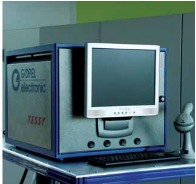
Das Testsystem TFS22 konnte alle Forderungen für eine Funktionsprüfung von Sitzen in der Endmontage entsprechend dem Lastenheft erfüllen.
