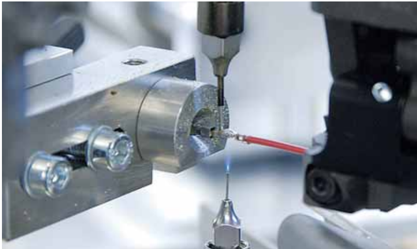
Der Schleuniger Kabelverarbeitungsautomat mit integriertem Spirflame Flammgenerator und patentierter Spirig Flammautomatisationskomponenten in Aktion.
