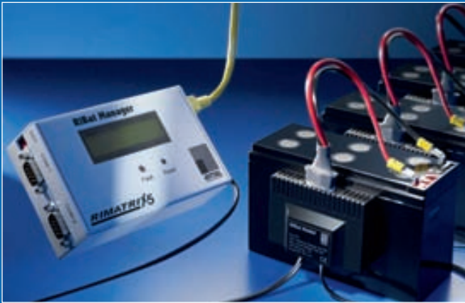
Ribat, das Management-System für die Batterien einer USV, kann deren Lebensdauer um bis zu 30 Prozent verlängern. Denn es vermeidet, dass eine Batterie, die sich im Verbund mit anderen Batterien befindet, überladen wird.
