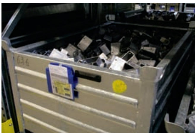
Die robusten auf den Behältern fixierten RFID-Transponder sorgen für eine eindeutige Identifizierung des Behälters. Ihre Vorteile: eine flache Bauform und gute Lesbarkeit auf Metall.
