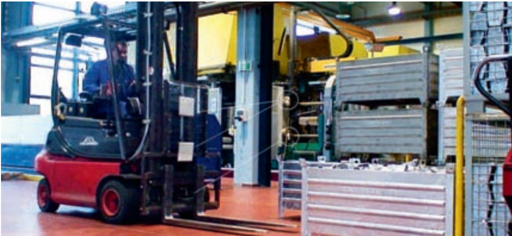
Der Gabelstapler verfügt über Ha-VIS RFID-Reader; die Gabel ist mit Antennen ausgestattet, die sich mitbewegen. Somit lassen sich alle Behälter erfassen, die vom Stapler aufgenommen werden.
