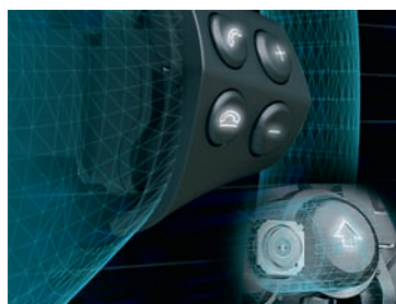
Mit der Kurzhubtaste 3006 lassen sich Tastenfelder im engen Raster aufbauen, wie in Multifunktionseinheiten von Lenkrädern.
