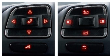
LTK-Anzeigetechnologie auf Basis der Lenkradschalter VW Passat CC: Die Basis-Funktionsbelegung (links) wechselt auf Knopfdruck.
