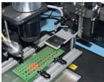
IR-XT5P-Reworksystem mit fokussiertem Infrarot (li.) und Reworkschablone (re.).
