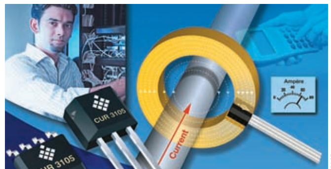
Der auf Hall-Effekt basierende Strommesswandler lässt sich optimal an die kontaktlose Strommessapplikation anpassen.
