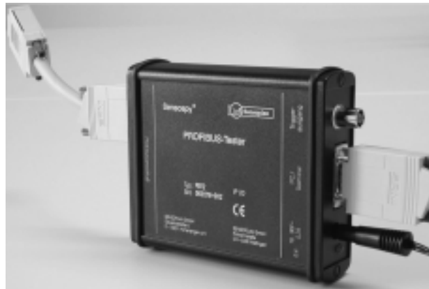
Spürt Fehler in Profibus-Systemen auf: Sensospy beurteilt die Pegelhöhe, Welligkeit und Flankensteilheit der Signale
