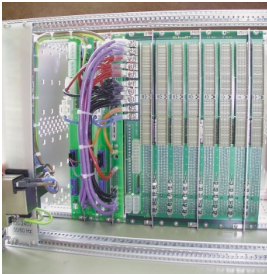
Die Adapterplatine wird an der hinteren Modulschiene befestigt; sowohl ein Netzteil als auch mehrere redundant arbeitende Geräte lassen sich räumlich beliebig im Baugruppenträger anordnen
