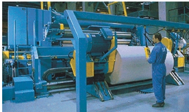
Hochwertige Maschinen wie Wickler und Rollgänge erfordern feldorientierte oder direkte Regelverfahren
