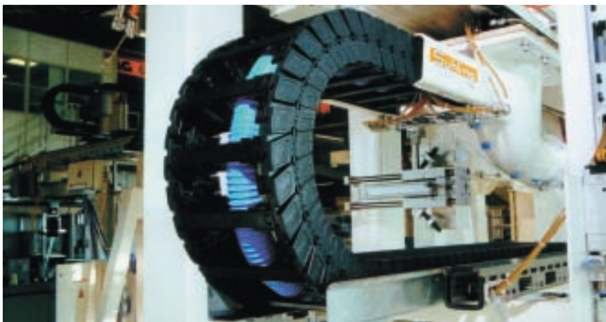
Suhling Technik minimiert die bewegten Massen durch den Einsatz von Kohlefaser-Elementen und optimal ausgelegte Energieführungsketten
