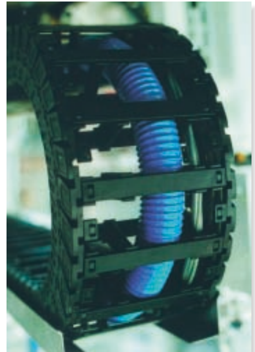
Im Umlenkpunkt üben elastische Verbindungselemente der E6-Energieführung eine Art Stoßdämpfer-Effekt aus und eliminieren so Belastungsspitzen
