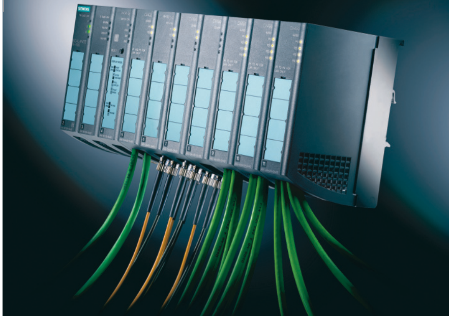
Industrial-Ethernet-Switches wie der Scalance X414-3E sind für Einsatzumgebungen im Umfeld von speicherprogrammierbaren Steuerungen wie Simatic S7 konzipiert.
