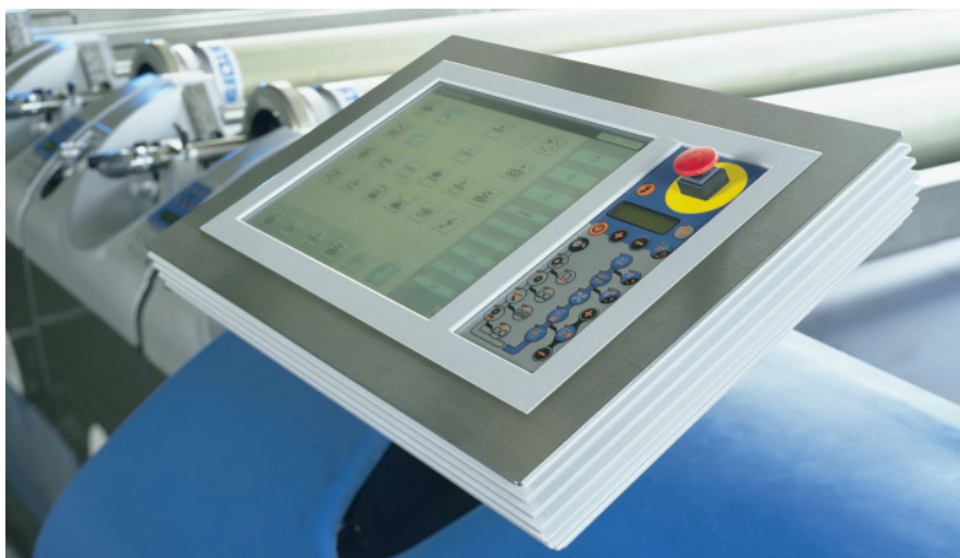
Zentrale Kontrolle: Mit dem zentralen Bedienterminal hat man alle Funktionen der Textildruckmaschine im Griff. Es ist vollkommen gekapselt, erfüllt Schutzklasse IP65 und arbeitet ohne Lüfter.
