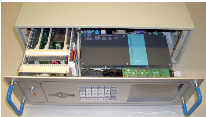
Ultrakompakter Industrie-PC als leistungsfähige und robuste Recheneinheit für die Messsteuerung.
