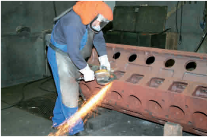
Mit einem Turbo-schleifer werden die gegossenen Motorblöcke entgratet.
