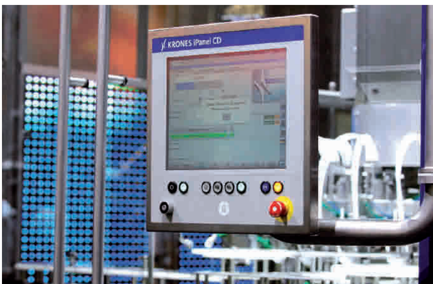
Das Display an der Maschine, den Rechner sicher verstaut im Schaltschrank – das ermöglicht Flexibilität ohne Einschränkungen durch die industrielle Umgebung.
