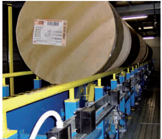
Der Abstand der Papierrollen wird durchgängig überwacht und gesteuert.
