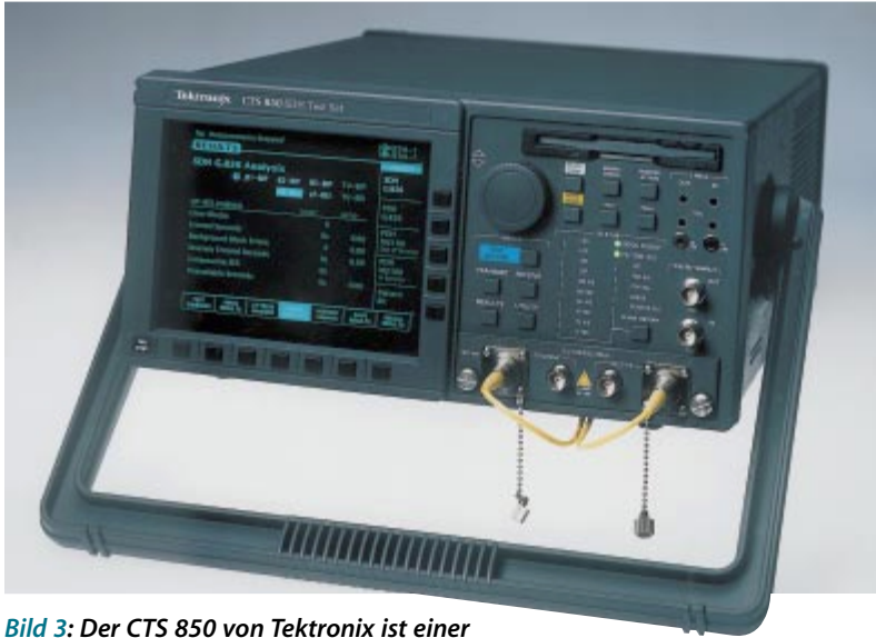
Bild 3: Der CTS 850 von Tektronix ist einer der ersten SDH/PDH-Jitter/Wander-Messplätze, der die Anforderungen des neuen Standards O.172 erfüllt
