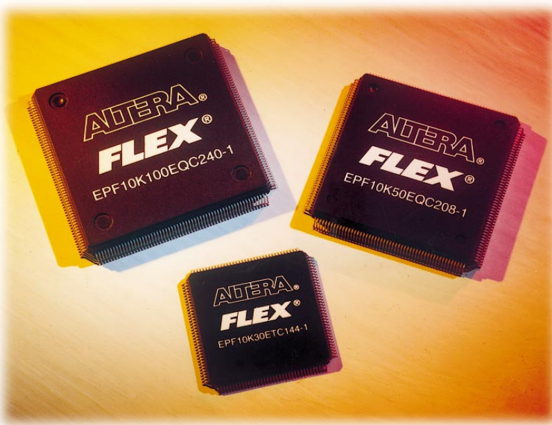
Bild 1: Unter Nutzung parametrisierbarer IP-Cores lassen sich in PLDs wie den hier gezeigten FLEX-Bausteinen Filter effektiv implementieren
