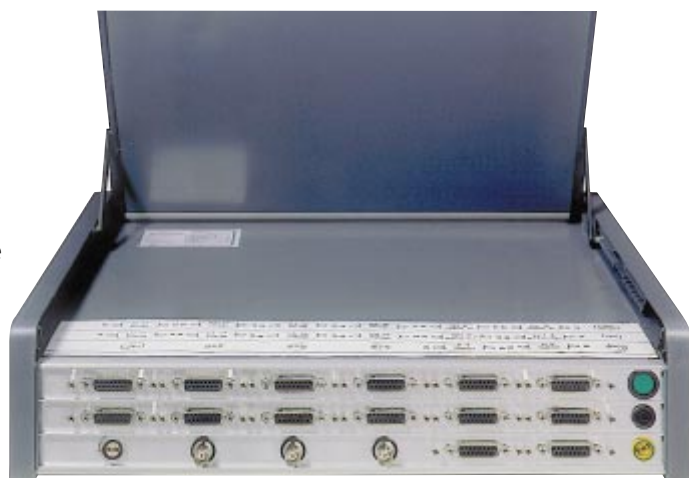
Bild 3: Die komplette Anschlußtechnik für alle Ein- und Ausgänge ist rückseitig vorhanden. Alle Anschlußbuchsen sind als gängige D-Sub-Typen bzw. als BNC ausgelegt
