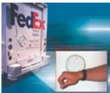
Smart-Labels lassen sich überall integrieren: vom Kleidungsstück über den Schlüsselanhänger bis hin zur Armbanduhr. In diesem Fall realisiert der Kurierdienst FedEx die Zugangskontrolle zum Laderaum mit Hilfe eines in die Armbanduhr integrierten Tags. Foto: Texas Instruments
