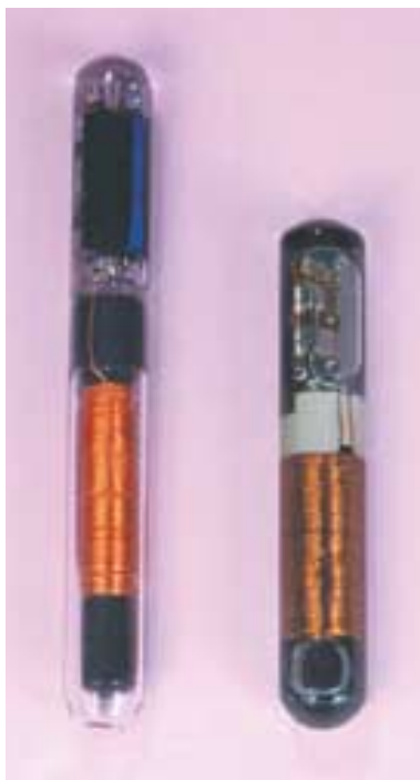
Tags, die beispielsweise in Tiere implantiert werden, sind meist in einem verschlossenen Glasbehälter untergebracht. Foto: Texas Instruments
