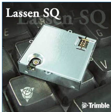
Bild 3: Lassen SQ, das im Text genannte Modell M-Loc ist baugleich und misst ebenfalls nur 26 x 26 x 6 mm.
