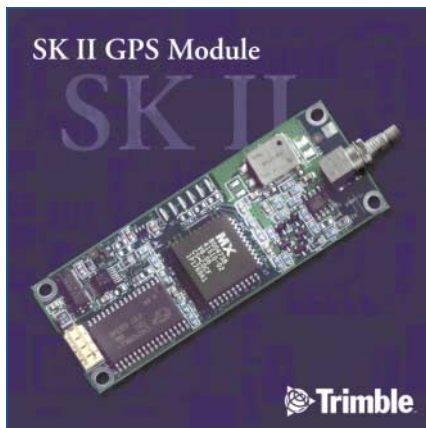
Bild 2: GPS-Empfangsmodul Lassen SKII, es wird von vielen bekannten Kfz-Herstellern eingesetzt.
