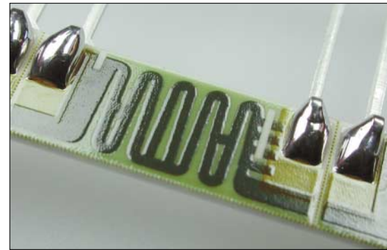
Bild 3: Widerstand mit sichtbarem Trimmschnitt. Die Abdeckung des Widerstandes im Hochspannungs-Generator dient primär als Schutz bei Transport und Handling.
