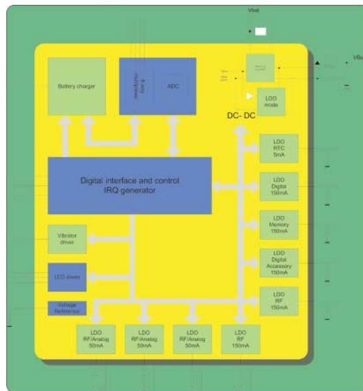
Bild 1: Hauptelemente eines typischen Powermanagement-ICs.
