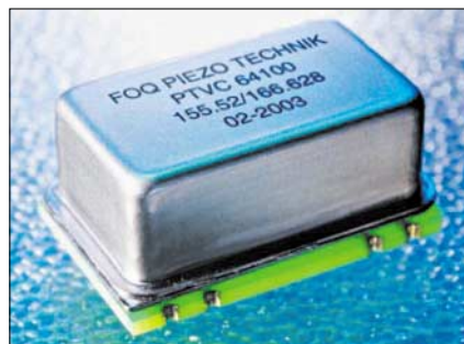
Bild 2: VCXO in einer Version als Doppel-VCXO mit zwei Ausgangsfrequenzen, die im Bereich bis 800 MHz liegen können. Mit einem Baustein können so z. B. unterschiedliche Send- und Empfangsfrequenzen erzeugt werden. Der Ziehbereich ist ±100ppm der Nennfrequenz für jeden VCXO. (Quelle: FOQ)
