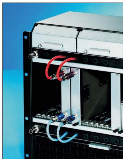
Bild 4: Hybridlösung: kombinierte Wasser- und Luftkühlung im Chassis
